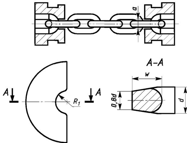
$a$  — размер  $d_1$  из таблицы 1;  $d$  — номинальный диаметр материала (проката) в готовой цепи;  $R_1 = \frac{a}{2}$ ;  $w$  — в зависимости от размеров захватов.
