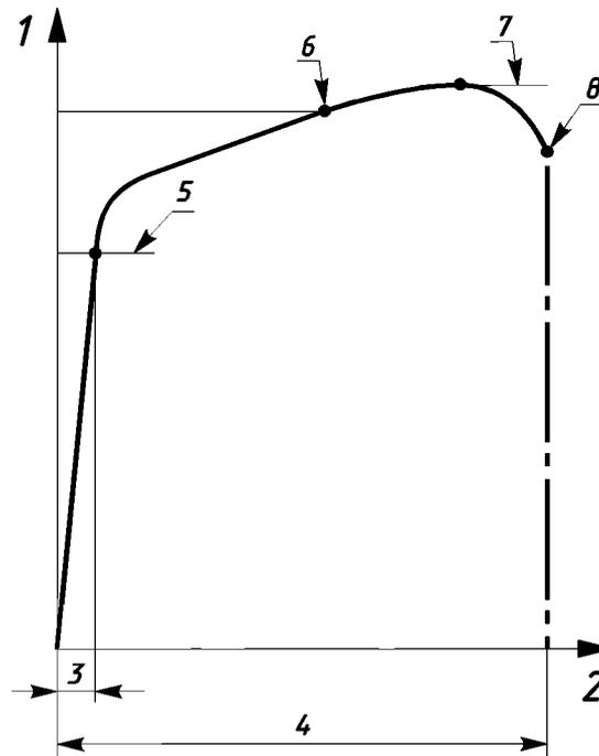
1 — нагрузка; 2 — удлинение; 3 — общее удлинение при пробной нагрузке; 4 — общее удлинение при разрыве; 5 — предписанная пробная нагрузка; 6 — предписанная минимальная разрушающая нагрузка; 7 — разрушающая нагрузка; 8 — момент разрыва
