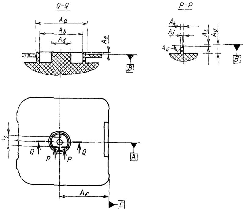
$$A_a \leq 17,27 \text{ мм}; A_b \geq 14,60 \text{ мм}; A_c \leq 8,30 \text{ мм}; A_d \leq 6,70 \text{ мм}; A_e \leq 0,38 \text{ мм}; A_f = 40,84 \text{ мм};$$
