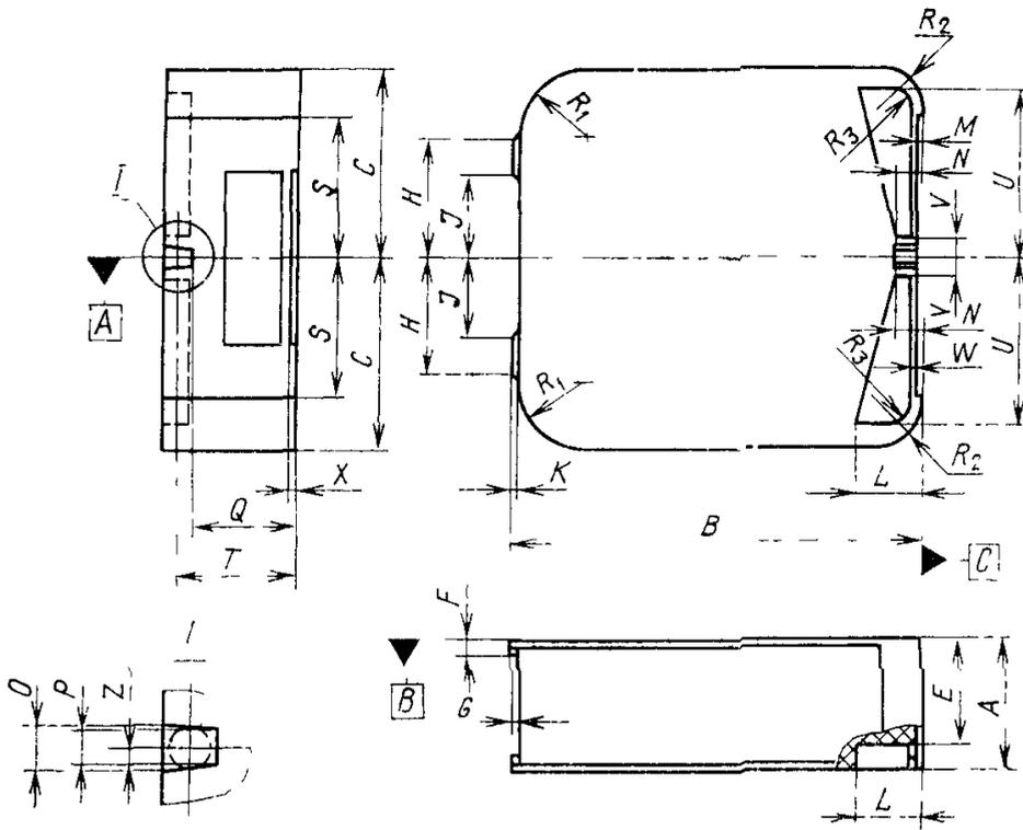
$A=24,23\pm 0,25$  мм;  $B=75,90\pm 0,30$  мм;  $C=35,30\pm 0,25$  мм;  $E < 19,80$  мм;
