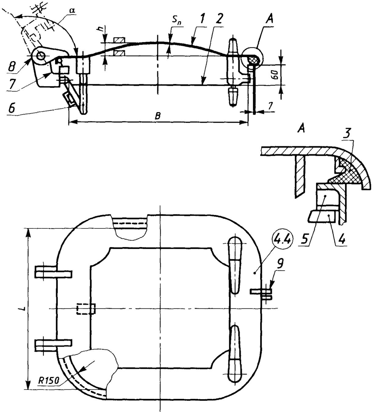
1 — полотно; 2 — зашивка; 3 — уплотнительная прокладка; 4 — задрайка; 5 — клин; 6 — стопор; 7 — ко-
