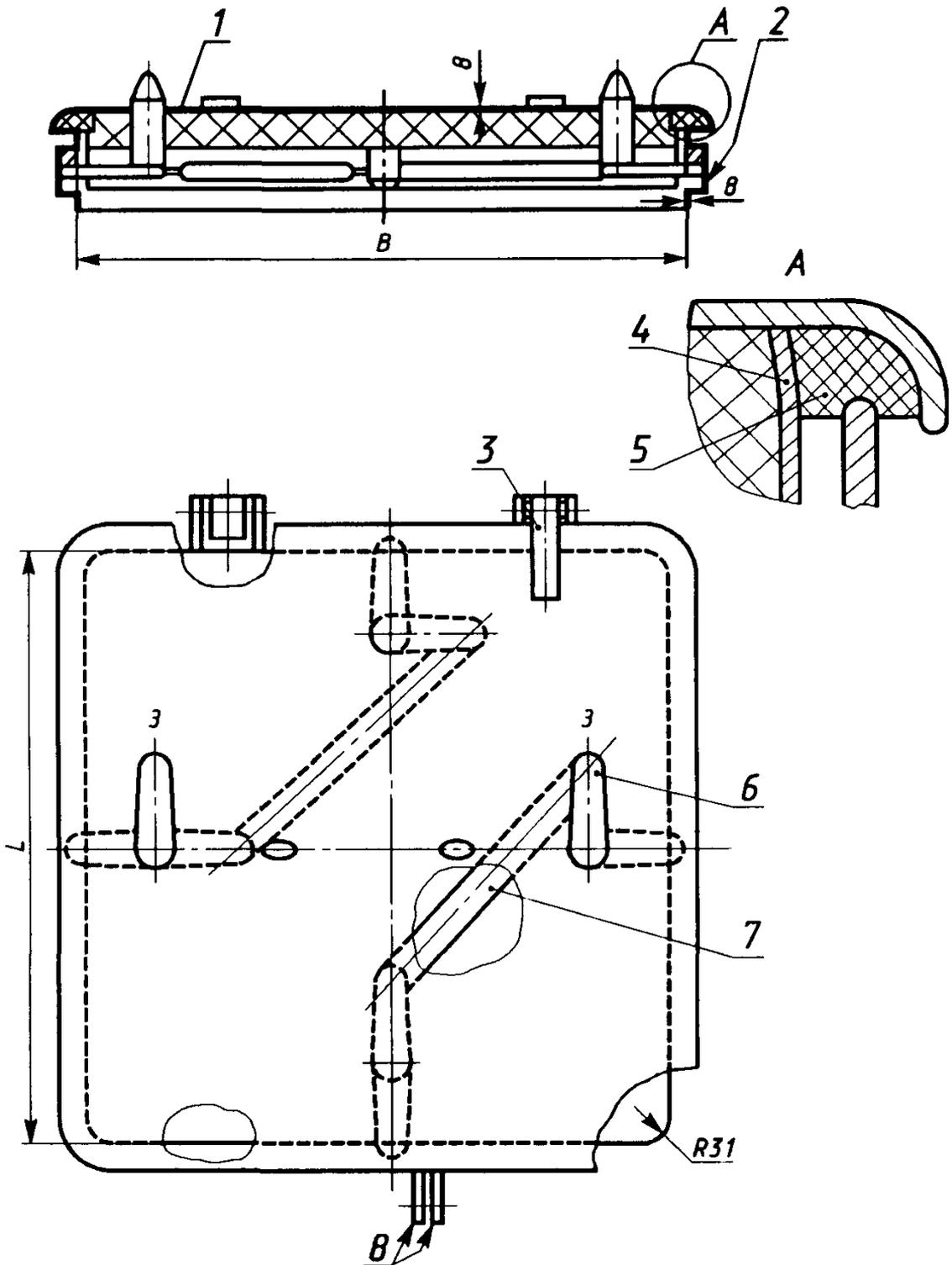
1 — полотно; 2 — комингс; 3 — петля; 4 — держатель; 5 — уплотнительная прокладка; 6 — ручка-защайка; 7 — рычаг; 8 — обушок для замка
