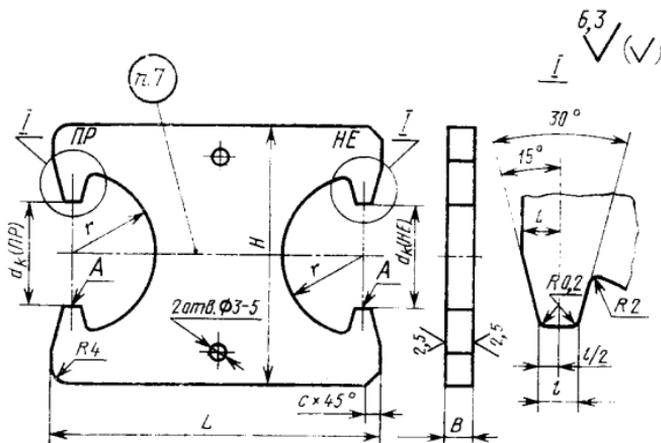
Примечание. Допускается не изготавливать отверстия диаметром 3—5 мм.
