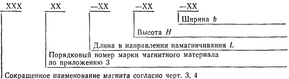
Пример условного обозначения призматического магнита с плоскопараллельными полюсами с порядковым номером марки
