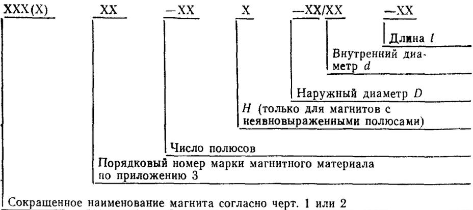
Пример условного обозначения звездообразного магнита с внутренними полюсами с порядковым номером марки магнитного материала 07, числом полюсов 4, неявновыраженными полюсами, с наружным диаметром 40, внутренним — 20, длиной 25 мм:
