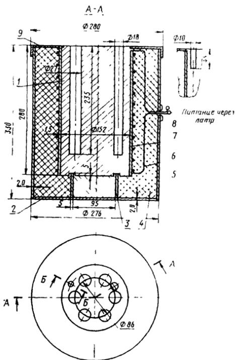
1—корпус блока; 2—дно; 3—пластина опорная;
