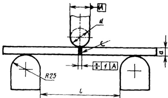
$$a = 3-5 \text{ мм}; d=2a; \quad =15 \pm 2,5 a$$
