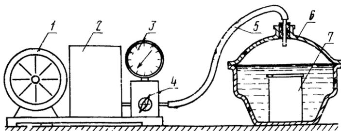
1 — электродвигатель; 2 — вакуумный насос; 3 — вакуумметр; 4 — трехходовый кран;
