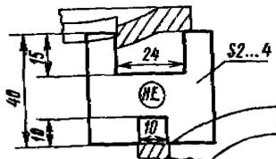
Примечание. Отклонения размеров калибров, указанных на чертеже, не должны быть более  $\pm 0,1$  мм.
