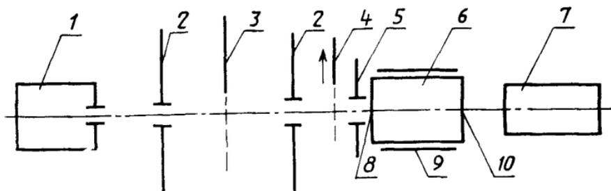
1—источник света; 2—светозащитная диафрагма; 3—заслонка; 4—непрозрачный диск; 5—диафрагма; 6—ЭОП; 7—яркомер; 8—фотокатод; 9—держатель ЭОП; 10—край
