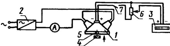
1 — рефлектометр; 2 — регулятор напряжения с точностью до 0,1 % с трансформатором, регулирующим выходное напряжение ламп рефлектометра; 3 — гальванометр с градуировкой от 0 до 100 % с фотоэлементом; 4 — градуировка — исходный условный уровень: белая поверхность, 99 %-ный серноокислый барий без защитного слоя; 5 — раскрыв; 6 — потенциометр для градуировки гальванометра; 7 — выключатель
