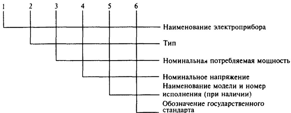
Пример условного обозначения радиационного электрогриля закрытого исполнения, номинальной потребляемой мощностью 1 кВт, на номинальное напряжение 220 В, модели «Огонек»:
