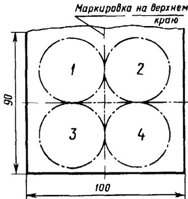
1, 2, 3, 4 — поля измерения на ломтиках (положение отверстия плитки рефлектометра)
