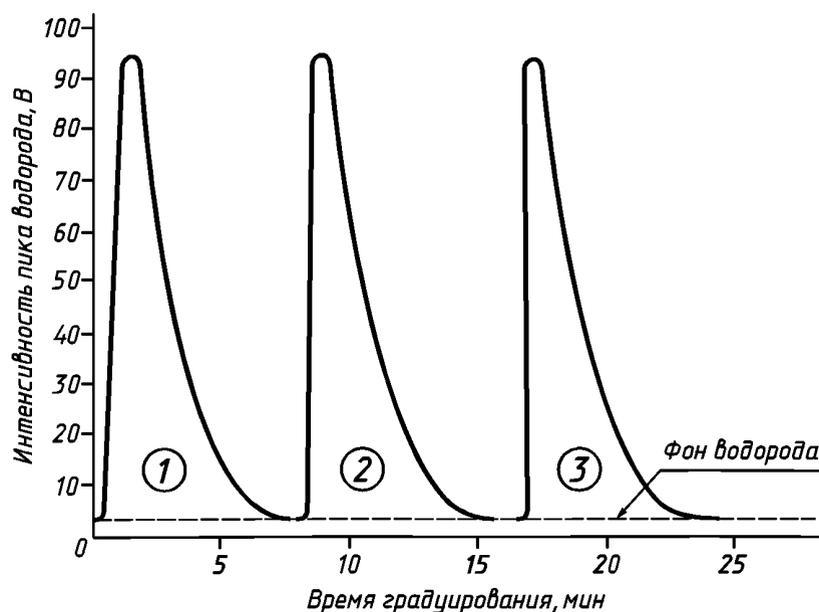
Рисунок 4 — Кинематические кривые при газовом градуировании
