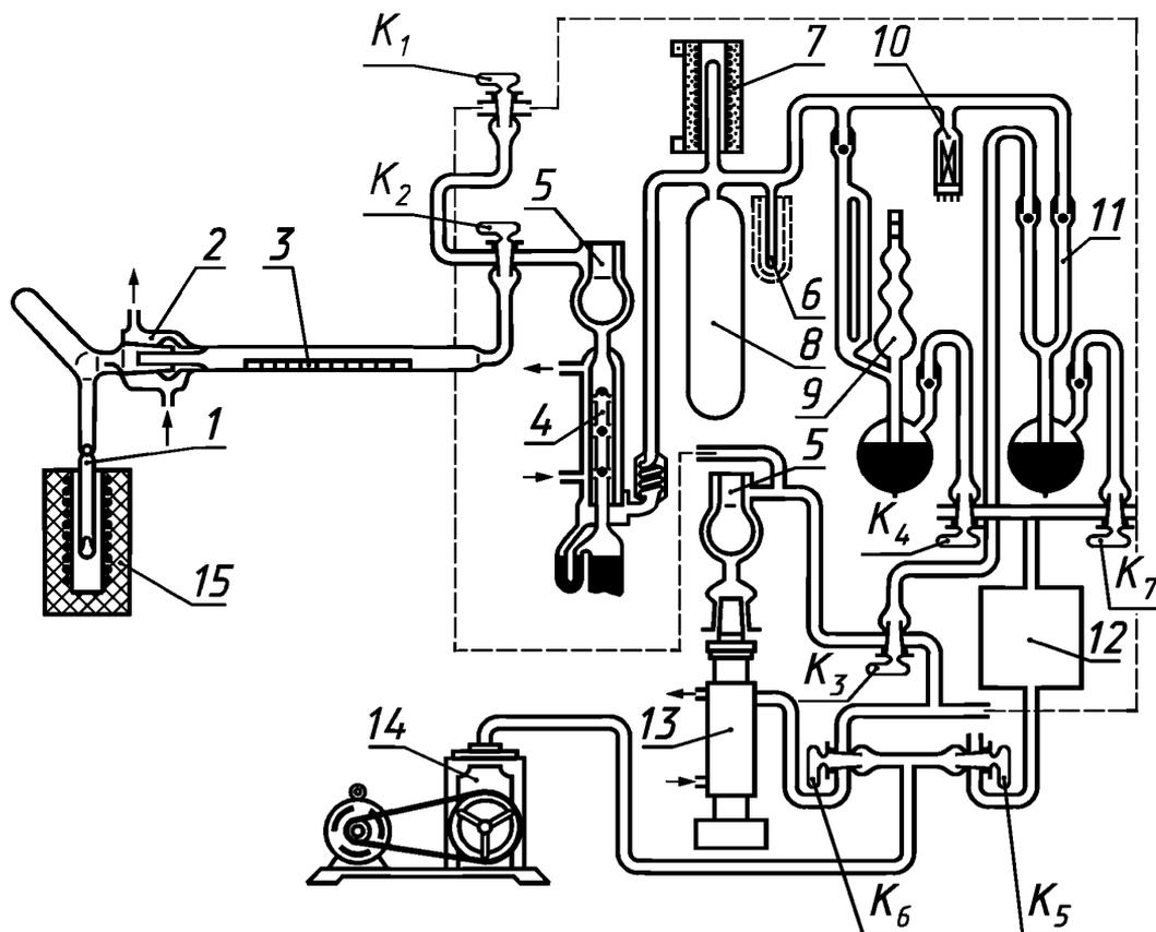
Рисунок 1 — Схема установки вакуум-нагрева с анализатором по давлению
