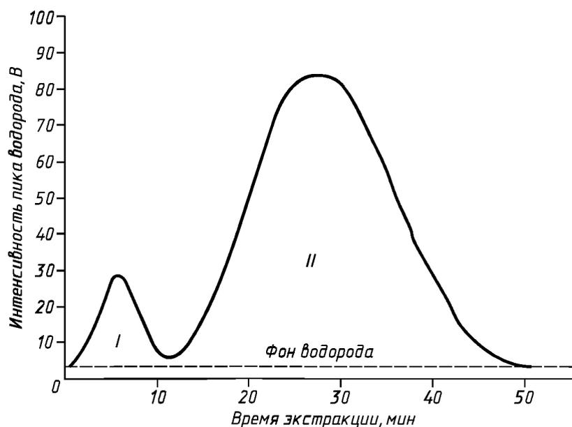
*I* — площадь под кинетической кривой выделения «поверхностного» водорода,  $S_I$ , см<sup>2</sup>; *II* — площадь под кинематической кривой выделения анализируемого водорода,  $S_{II}$ , см<sup>2</sup>
