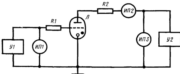
*R1, R2*—резисторы; *ИП1, ИП3*— измерители напряжения; *ИП2*— измеритель тока; *Л*—испытываемый тиратрон, *У1, У2*—регулируемые источники постоянного напряжения
