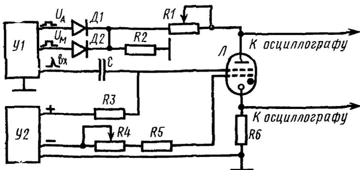
$R1, R2, R3, R4, R5, R6$  — резисторы;  $C$  — конденсатор;  $D1, D2$  — диоды;  $L$  — испытываемый тиратрон (газотрон);  $U1$  — источник импульсов с устройством, регулирующим смещение между импульсами  $U_A$  и  $U_M$ ;  $U2$  — источник постоянного напряжения
