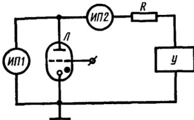
*R* — резистор; *ИП1* — измеритель напряжения; *ИП2* — измеритель тока; *Л* — испытуемый тиратрон (газотрон); *У* — регулируемый источник постоянного напряжения
