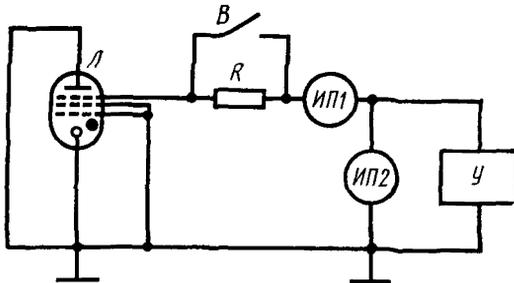
$R$  — резистор;  $В$  — выключатель;  $ИП1$  — измеритель тока;  $ИП2$  — измеритель напряжения;  $Л$  — испытываемый тиратрон;  $У$  — регулируемый источник постоянного напряжения
