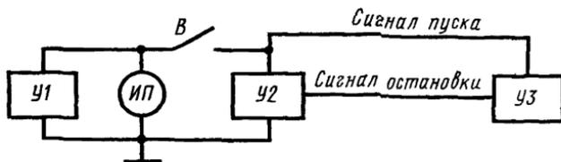
$В$ —выключатель;  $ИП$ —измеритель напряжения;  $У1$ —регулируемый источник постоянного напряжения;  $У2$ —устройство коммутации и испытываемый тиратрон;  $У3$ —измеритель временных интервалов
