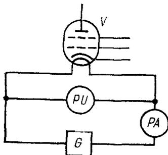
*G* — источник питания подогревателя (катода); *PA* — амперметр; *PV* — вольтметр; *V* — испытываемая лампа
