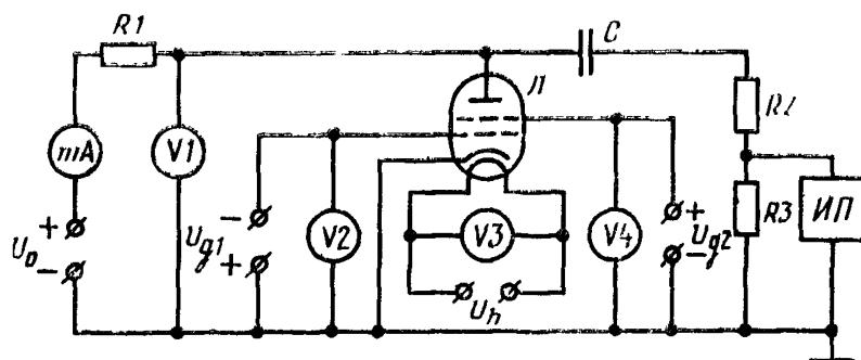
$R1$ —зарядный резистор;  $R2$ —ограничительный резистор;  $R3$ —измерительный резистор;  $C$ —накопительный конденсатор;  $mA$ —миллиамперметр;  $V1$ — $V4$ —вольтметры;  $ИП$ —счетчик искрений;  $L$ —испытуемая лампа
