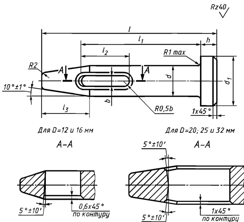
Примечание. Для  $d$  с предельными отклонениями по е8 шероховатость поверхности  $Ra = 1,25$  мкм.
