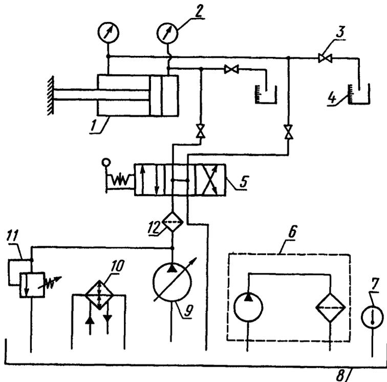
1 - испытуемый гидроцилиндр; 2 - манометр; 3 - вентиль; 4 - мерная емкость;
