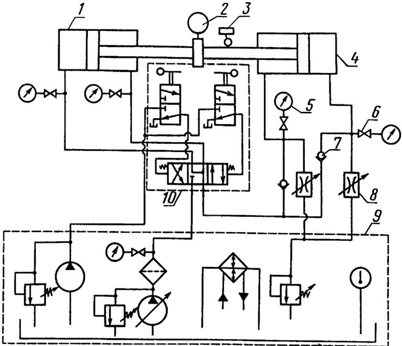
1 - испытуемый гидроцилиндр; 2 - динамометр; 3 - выключатель; 4 - гидроцилиндр нагрузочный; 5 - манометр; 6 - кран-демпфер; 7 - обратный гидроклапан; 8 - дроссель; 9 - насосная станция; 10 - гидрораспределитель с механогидравлическим управлением
