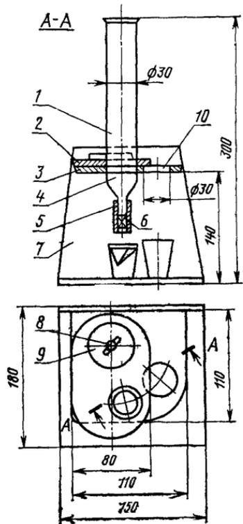
1—стеклянный цилиндр; 2—верхняя пластина; 3—нижняя пластина; 4—приемная воронка; 5—резиновая трубка; 6—зажим; 7—стойка; 8—болтовое соединение; 9—шайба; 10—отверстие для слива суспензии
