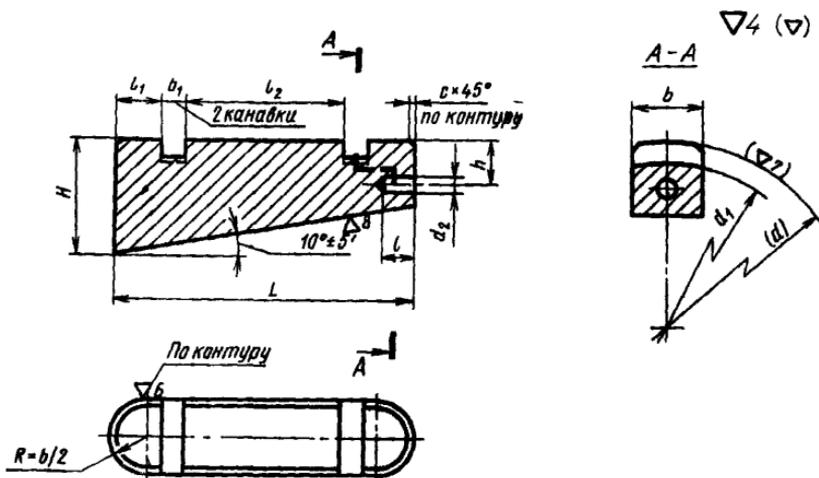
Примечание. Размер  $d$  и шероховатость поверхности в скобках — после сборки.
