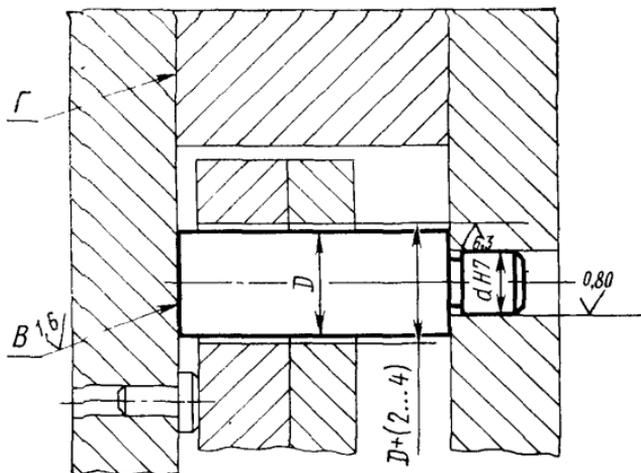
Отклонение поверхностей  $B$  и  $\Gamma$  от общей прилегающей плоскости — не более 0,05 мм.
