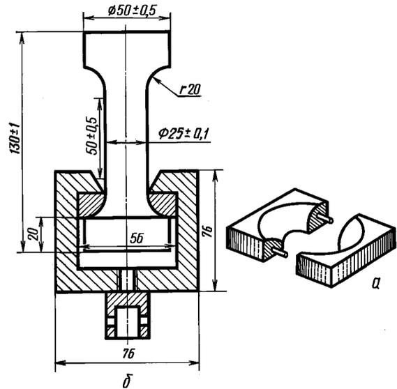
а — разъемный вкладыш; б — захват
