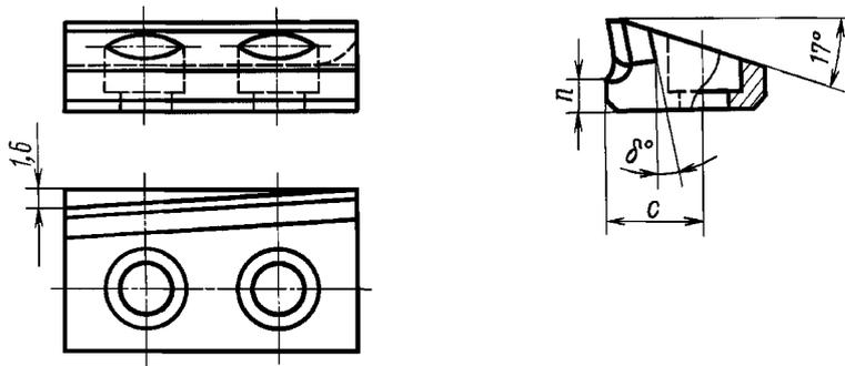
*Ножи для разверток диаметром св. 145 до 300 мм*
