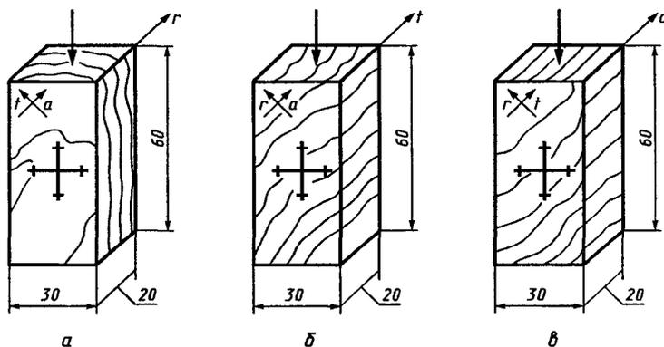
*a* — в радиальной плоскости при сжатии под углом  $45^\circ$  к направлению волокон и радиальной плоскости (тангентальный образец); *b* — в тангентальной плоскости при сжатии под углом  $45^\circ$  к направлению волокон и тангентальной плоскости (радиальный образец); *v* — в радиальной или тангентальной плоскости при сжатии под углом  $45^\circ$  к радиальной и тангентальной плоскостям (торцовый образец)
