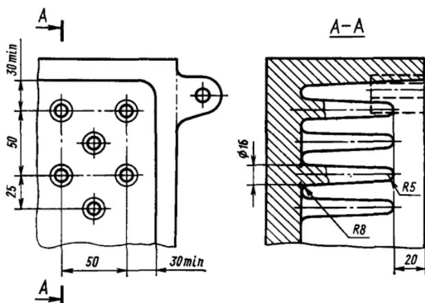
3. Для охлаждения металлических форм размерами более  $320 \times 320$  мм принимать ребра жесткости по ГОСТ 16238-70.
