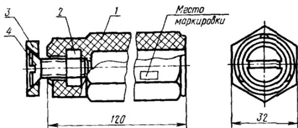
1 — корпус; 2 — гайка М10.6.05 ГОСТ 5927—70; 3 — шайба
