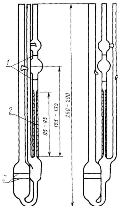
1 — метки, соответствующие вместимости от 4 до 6 мм, 2 — капилляр диаметром от 0,55 до 0,65 мм, 3 — метки на-
