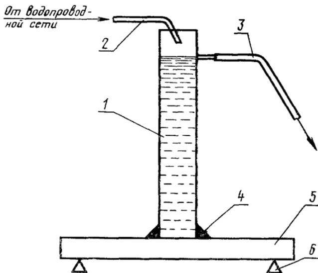
1—цилиндр; 2, 3—резиновый шланг; 4—герметизирующая замазка; 5—образец; 6—опора
