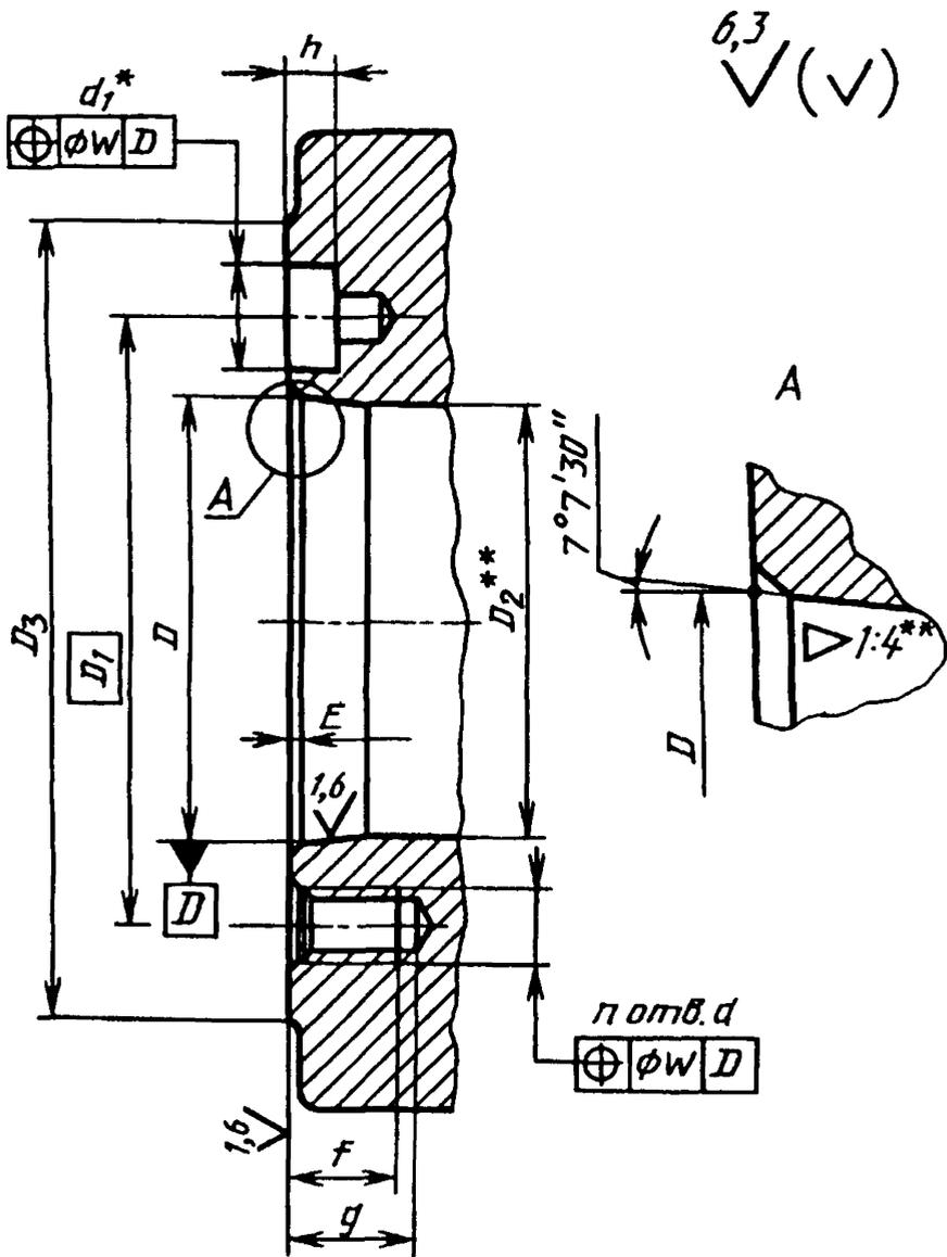
\* Фланцы зажимных устройств, устанавливаемых на концы шпинделей условного размера 3, должны изготавливаться без отверстия под поводковую шпонку.
