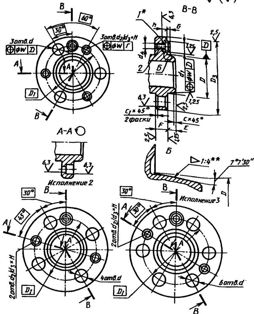
\* Концы шпинделей условного размера 3 должны изготавливаться без поводковой шпонки.
