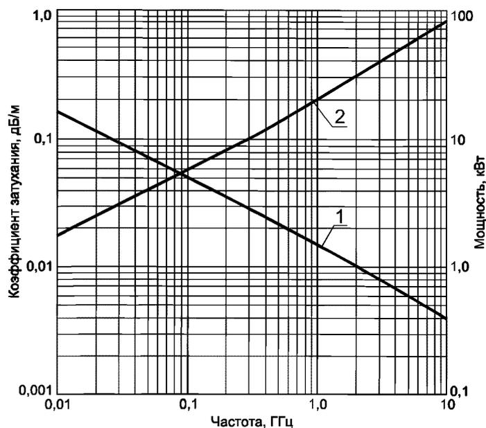
1 — допустимая мощность  $P$  на входе при температуре 40 °С и коэффициенте стоячей волны напряжения, равном 1;
