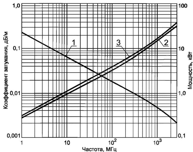
1 — допустимая мощность  $P$  на входе при температуре 40 °С и коэффициенте стоячей волны напряжения, равном 1;
