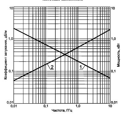
1 — допустимая мощность P на входе при температуре 40 °C и коэффициенте стоячей волны напряжения, равном 1; 2 — коэффициент затухания  $\alpha$  при температуре 20 °C
