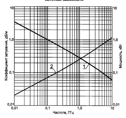
I — допустимая мощность P на входе при температуре 40 °C и коэффициенте стоячей волны напряжения, равном 1; 2 — коэффициент затухания  $\alpha$  при температуре 20 °C
