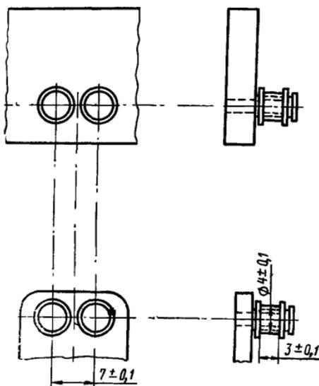
минимальную растягивающую силу, действующую на образец при испытании, не более 1 Н (100 гс), максимальную — 20 Н (2000 гс);
