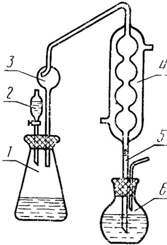
1—коническая колба; 2—капельная воронка; 3—брызгоуловитель, 4—холодильник; 5—отводная трубка, 6—приемник.
