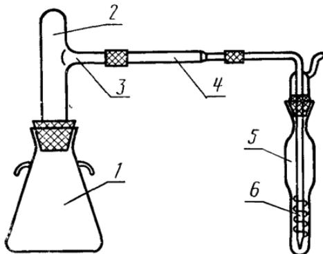
1—коническая колба вместимостью 100—150 см<sup>3</sup>; 2—удлинитель; 3—боковой отвод; 4—фильтрующая трубка длиной 5 см; 5—поглощительный сосуд внутренним диаметром 1 см, высотой 10 см; 6—вводная трубка, заканчивающаяся капилляром и навинченной стеклянной спиралью.
