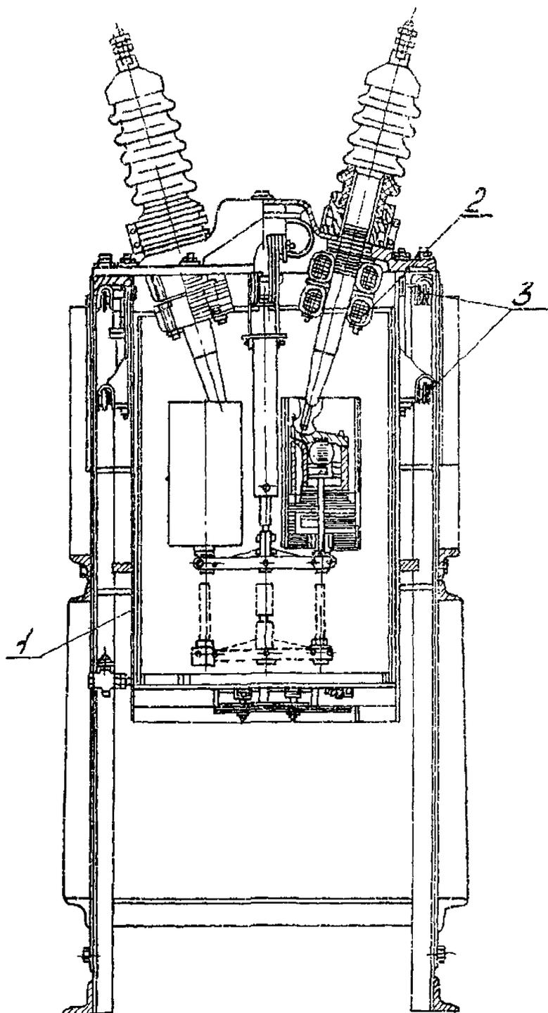
Рис. 2. Выключатель МКП-35-1000-25:
