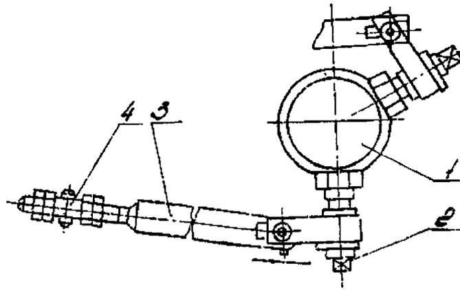
**Рис.8. Передача от вала привода к быстродействующим блок-контактам.**
