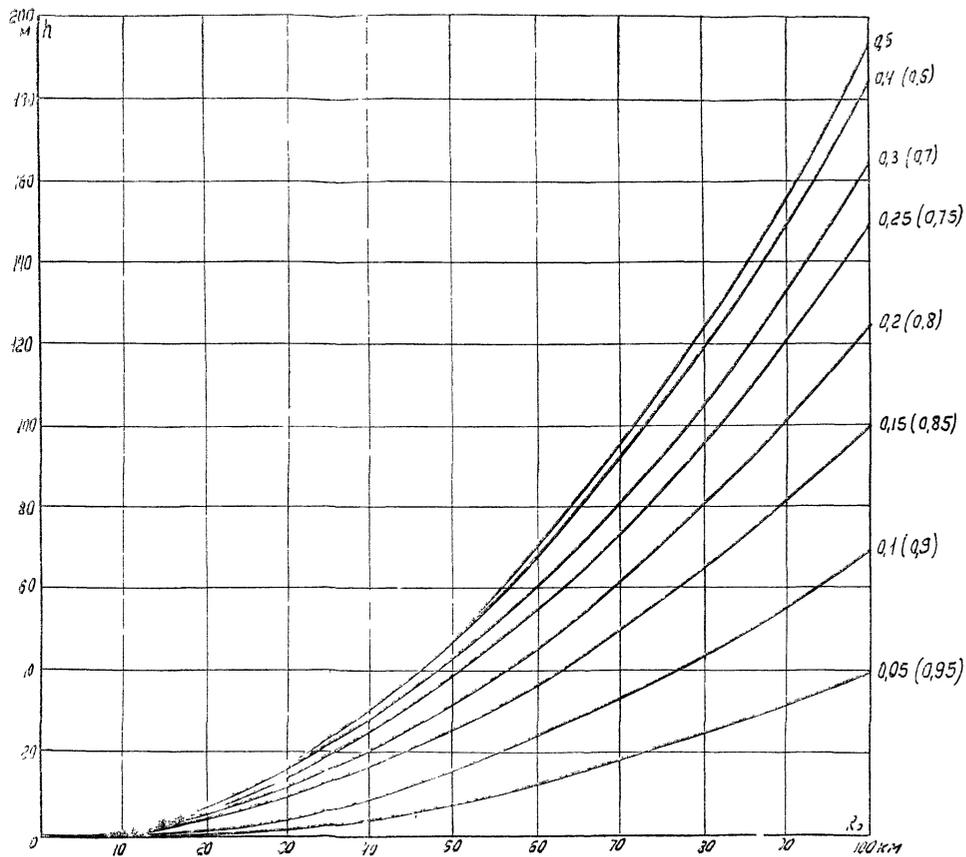
Рис 5 График значений  $h$  для построения кривизны земной поверхности
