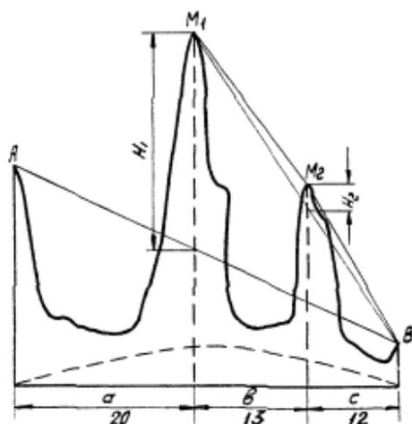
Рис. 15. Профиль трассы радиоканала к примеру 2.
