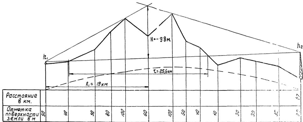
Рис. 14 Профиль трассы радиоканалов к примеру 1.
