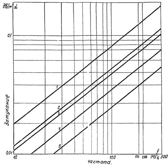
Рис. 2. Частотная зависимость величины затухания для кабелей марок:
