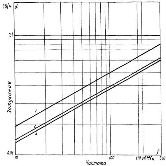
Рис. 1. Частотная зависимость величины затухания для кабелей марок:
