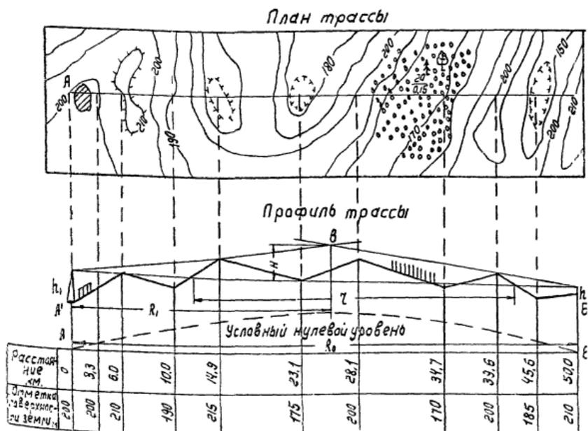
Рис. 4. Пример построения профиля трассы радиоканала
