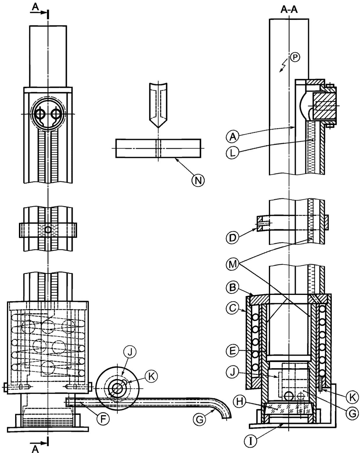
*A* — корпус; *B* — втулка; *C* — крышка втулки; *D* — зажимное кольцо; *E* — спускной патрубок; *F* — дренаж; *G* — дренажный кран; *H* — стеклянная шайба; *I* — фиксирующее кольцо; *J* — ось; *K* — пружина; *L* — змеевиковый нагреватель на 60 W; *M* — замазка для трубных соединений из окиси свинца и глицерина; *N* — ручка; крепится в точке «*D*»; *P* — трубка колориметра с делениями
