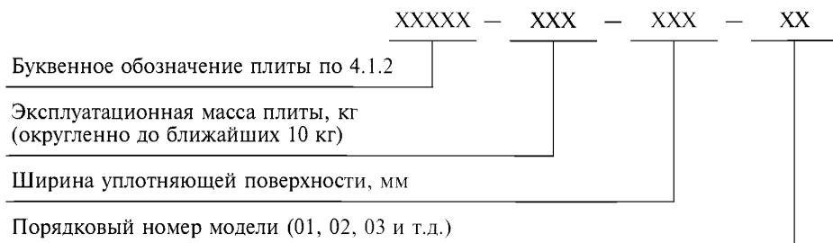
Пример условного обозначения вибрационной уплотняющей самоходной нереверсивной плиты эксплуатационной массой 114 кг, с уплотняющей поверхностью шириной 400 мм третьей модели:
