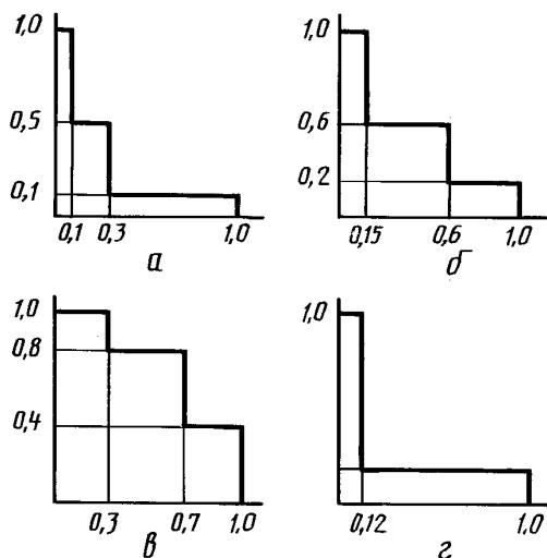
*a* — механизм роликового конвейера, цепного конвейера, сталкивателя груза; *б* — механизм подъема стола кривошипного или эксцентрикового типа; *в* — механизм подъема стола с постоянным усилием подъема (напр. винтовой механизм);
