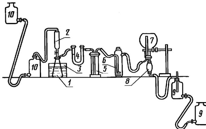
1— коническая колба; 2, 8— капельные воронки; 3— ванна для охлаждения колбы; 4— U-образная трубка; 5— склянка для промывания газа; 6— склянка для промывания газа со стеклянным пористым фильтром; 7— плоскодонная колба; 9— большой аспиратор; 10— малый аспиратор
