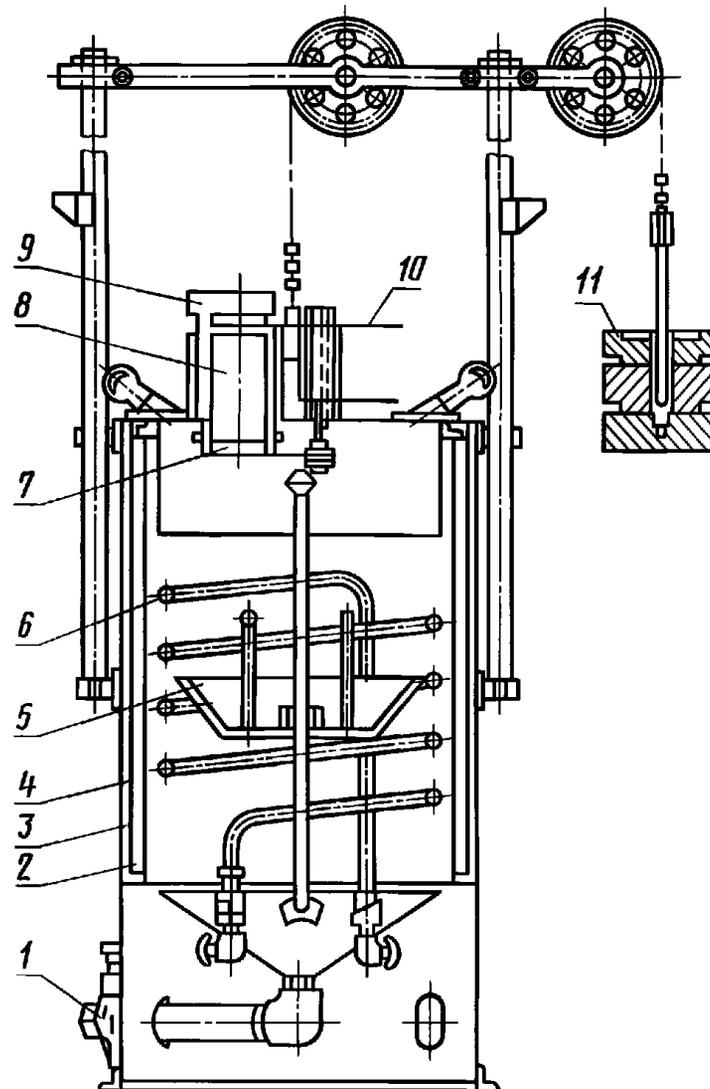
1 — сливной патрубкок; 2 — реактор; 3 — колокол; 4 — водяной затвор; 5 — перфорированный поддон; 6 — охлаждающий змеевик; 7 — заслонка; 8 — загрузочная камера; 9 — колпак; 10 — поворотное устройство; 11 — груз
