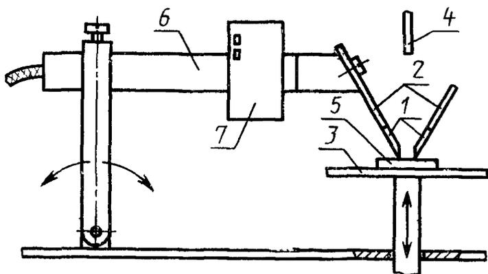
1 — платиновый электрод, 2 — медный удлинитель, 3 — опора, 4 — конец капельницы, 5 — образец, 6 — изоляционная трубка, 7 — груз
