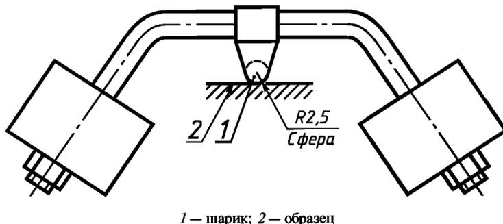
Рисунок 4 — Прибор для испытания вдавливанием шарика
