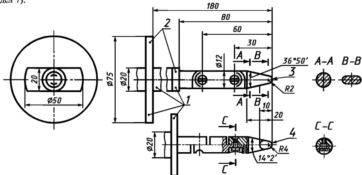
1 — изоляционный материал; 2 — стопорная плата; 3 — цилиндр; 4 — сфера
