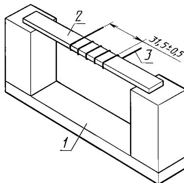
1 — опора для образца; 2 — образец; 3 — горячая проволока
