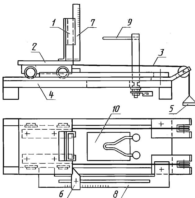
1 — зажим для образца; 2 — тележка; 3 — шнур для натяжения; 4 — опорная плитка; 5 — груз;
