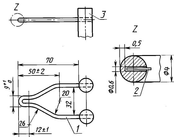
1 — раскаленная проволока, припаянная к шпильке; 2 — термопара; 3 — шпилька
