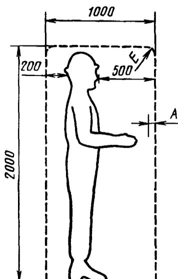
*A* — зазор 50 мм между органами управления и кабиной (+25 мм для работы в арктической спецодежде); *E* — максимальный радиус закругления в месте соединения внутренних стенок кабины друг с другом и с потолком равен 250 мм
