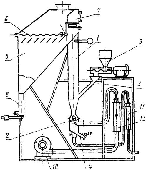
В комплект установки входят: печь, состоящая из трубчатой вертикальной шахты 1, горелки 2, установленной в нижнем ее конце, лотка 3 для подачи перлита в печь, сборника просыпи с затвором 4; камера осаждения вспученного перлита 5 с фильтром для очистки газов 6, муфель для термоподготовки перлита 7, накопительный стакан с затвором 8; узел дозированной подачи перлита в печь 9, дутьевой вентилятор 10; ротаметры 11 и 12 для измерения расходов газа и воздуха.
