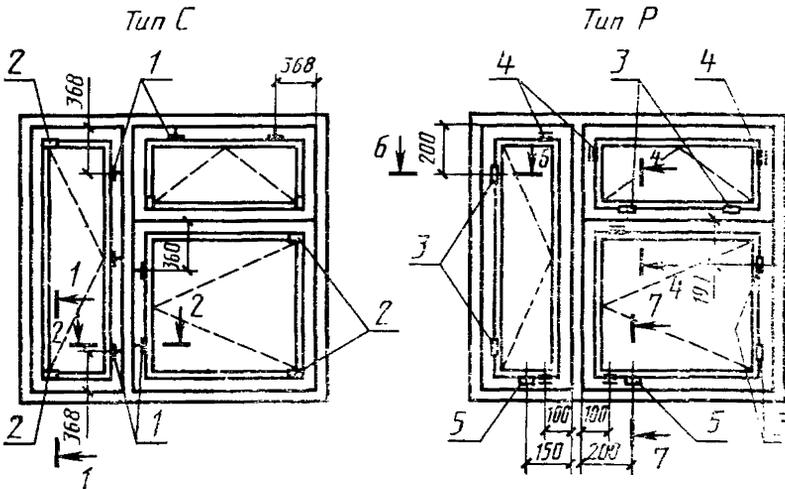
1 — завертка врезная типа ЗР1; 2 — петля для спаривания; 3 — петля; 4 — соединитель створок; 5 — компенсатор
