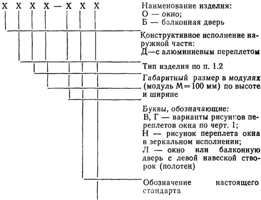
Пример условного обозначения деревоалюминиевого окна типа С с габаритными размерами по высоте 18М и ширине 9М, с вариантом рисунка окна В:
