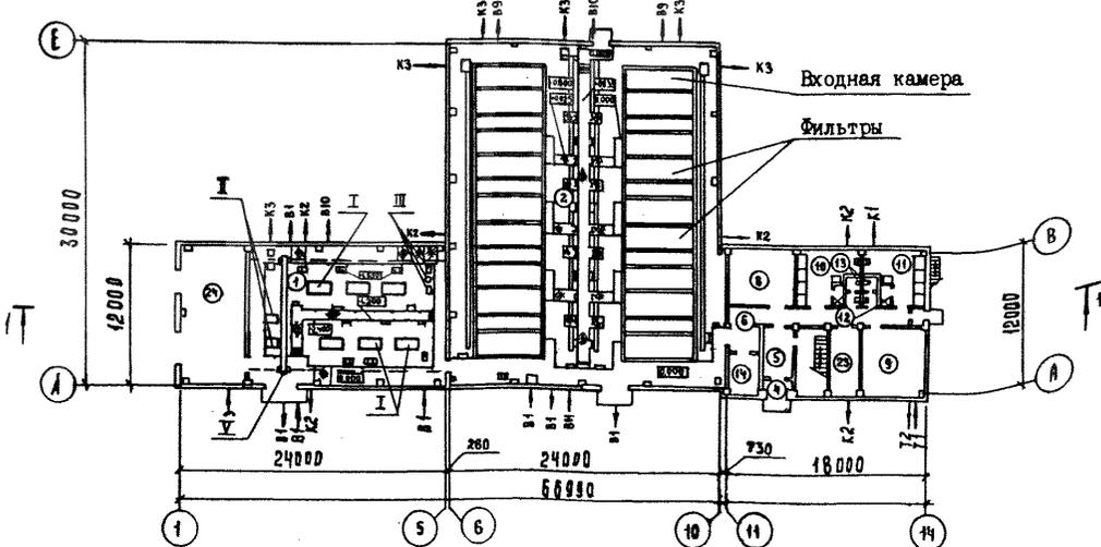
ЗДАНИЕ СТАНЦИИ ОБЕЖЕЛЕЗИВАНИЯ ВОДЫ ПОДЗЕМНЫХ ИСТОЧНИКОВ С СОДЕРЖАНИЕМ ЖЕЛЕЗА ДО 10 МГ/Л ПРОИЗВОДИТЕЛЬНОСТЬЮ 40,0 ТЫС. М<sup>3</sup>/СУТ.
