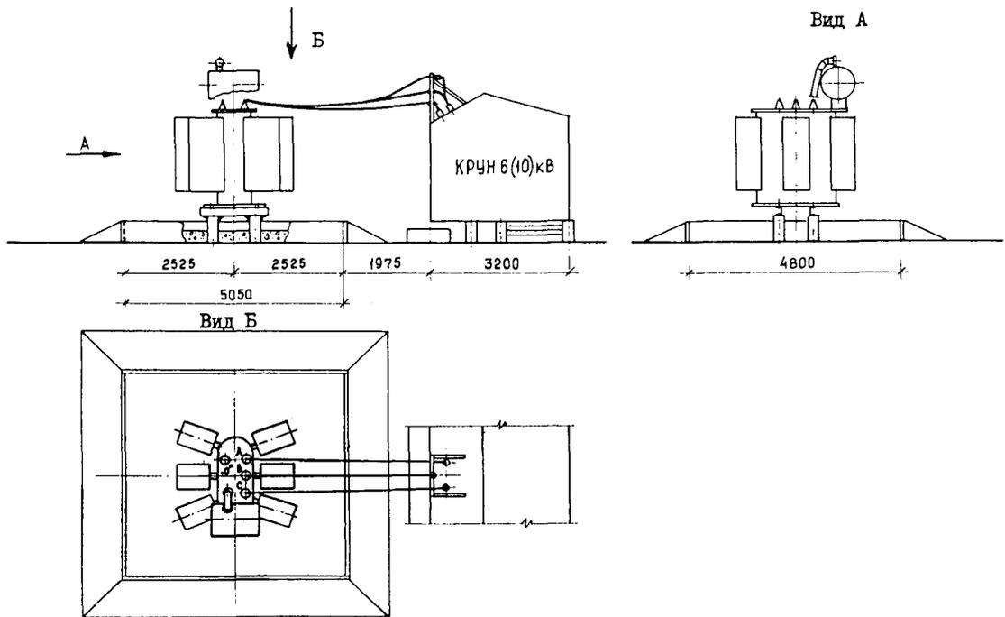
**УСТАНОВКА ГРУППЫ ОДНОФАЗНЫХ РЕАКТОРОВ**
