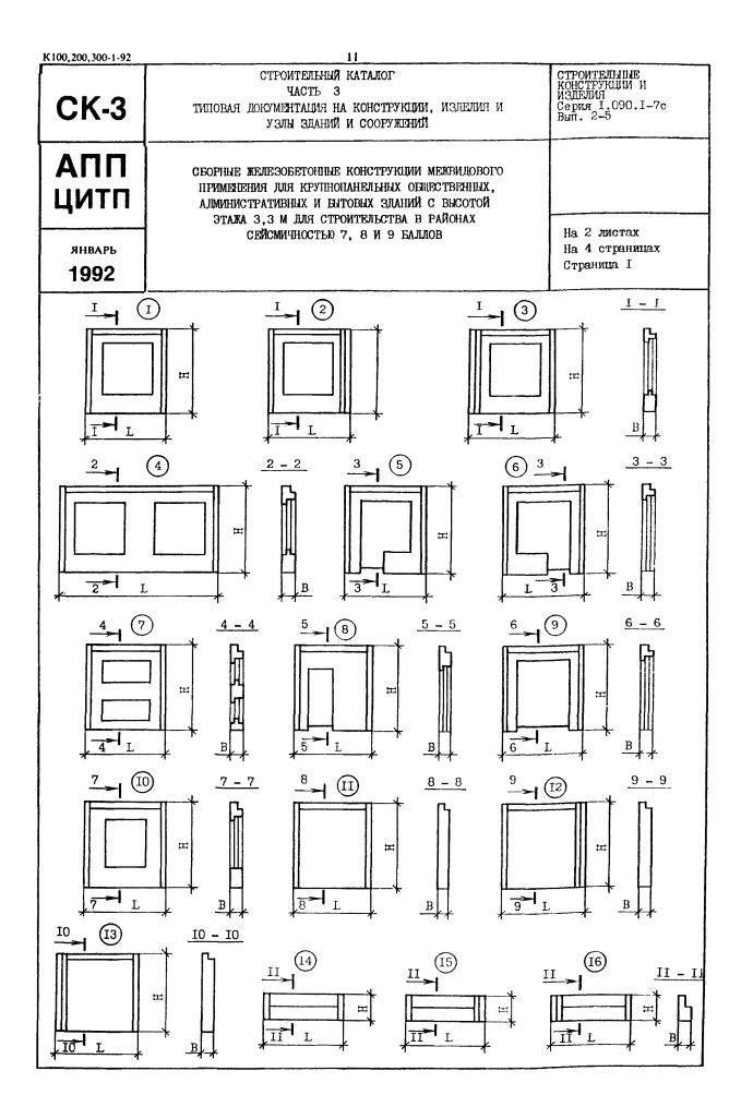
СБОРНЫЕ ЖЕЛЕЗОБЕТОННЫЕ КОНСТРУКЦИИ МЕЖВИДОВОГО ПРИМЕНЕНИЯ ДЛЯ КРУПНОПАНЕЛЬНЫХ ОБЩЕСТВЕННЫХ, АДМИНИСТРАТИВНЫХ И БЫТОВЫХ ЗДАНИЙ С ВЫСОТОЙ ЭТАЖА 3,3 М ДЛЯ СТРОИТЕЛЬСТВА В РАЙОНАХ СЕЙСМИЧНОСТЬЮ 7, 8 И 9 БАЛЛОВ
